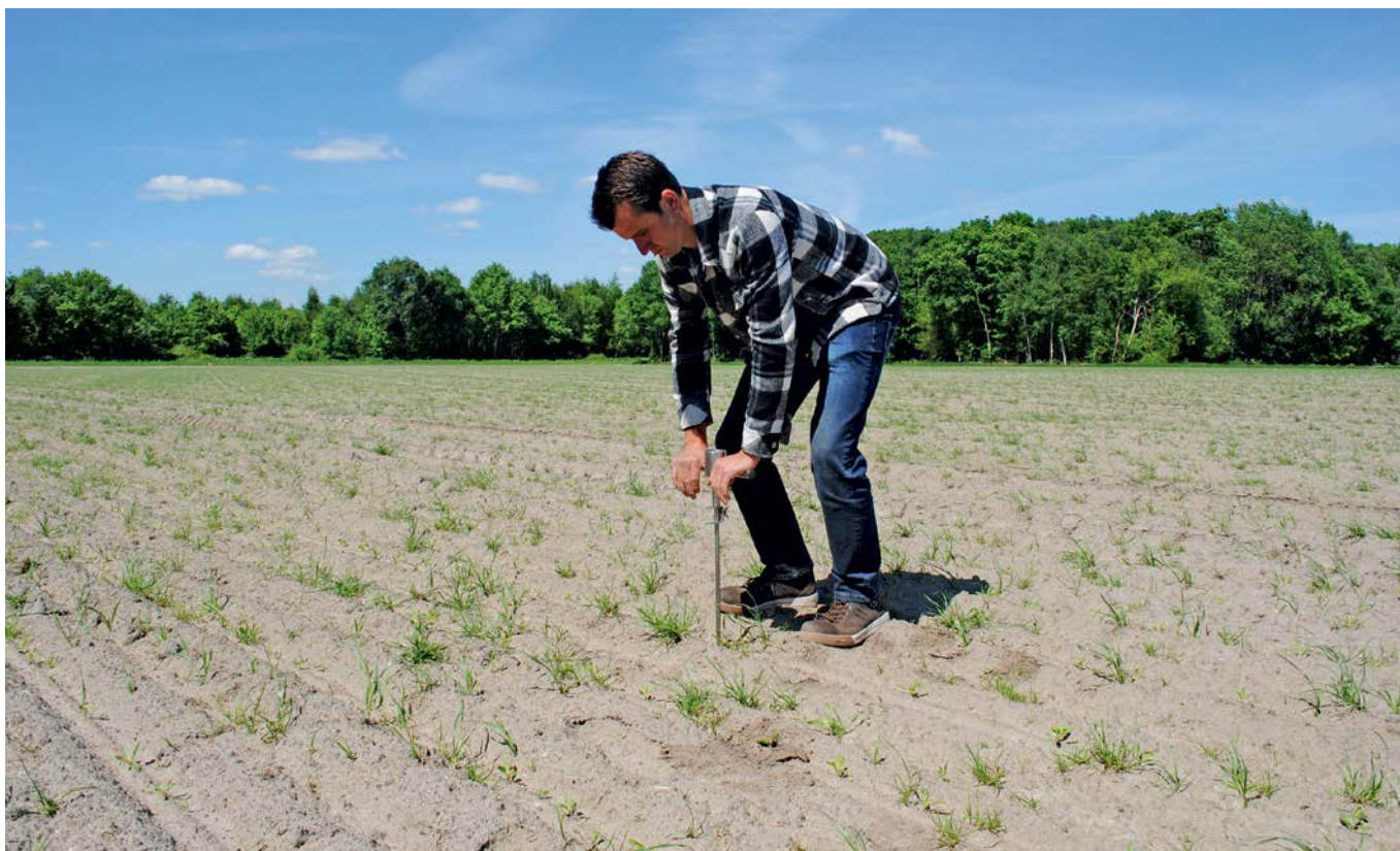
Bodemcoach Martijn van Vijfeijken kijkt met een penetrometer de indringweerstand op een perceel van Van Kempen.
